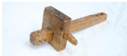
Ceci est un Trusquin, un outil de traçage opérant par translation sur une surface d'appui de référence. Il est utilisé dans l'atelier thérapie roudolien qui porte son nom. Voir la nouvelle plaquette de présentation.
